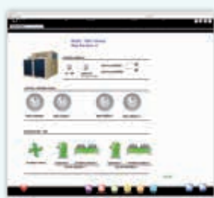
пользовательский экран Roof Top, Основные элементы управления блока: основные операции: старт - стоп, холод/ тепло, изменить заданные значения температуры и просмотреть статус ключевых компонентов.
